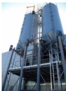
Une récupération de chaleur du procédé est réalisée pour sécher les boues et permettre de diminuer la consommation énergétique.
